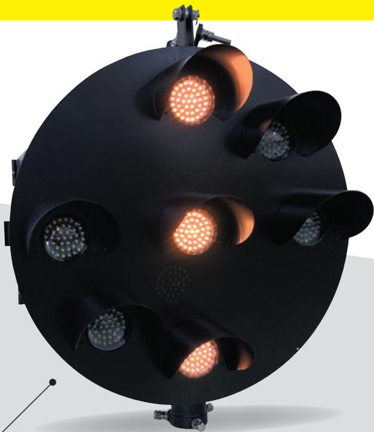
各現示とも3個の灯を直列点灯させ、断線等の故障時に不正現示しない構造
